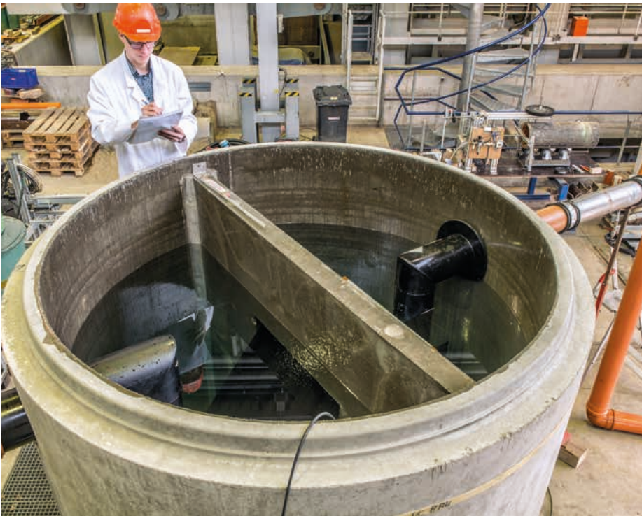
Die AgilEX 2000 hat bei den Laborprüfungen im IKT ihre Reinigungsfähigkeiten bewiesen.
